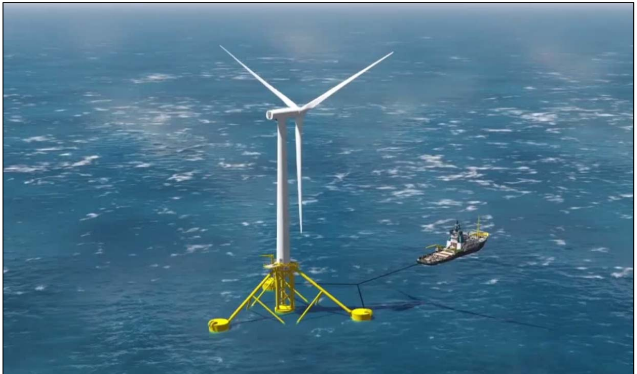
Figure 34 : Vue artistique du remorquage de l'éolienne flottante (© SBM Offshore)
