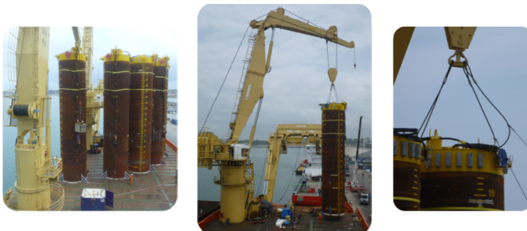
Figure 27 : Chargement typique des ancrs sur le pont – illustration (© SBM Offshore)
