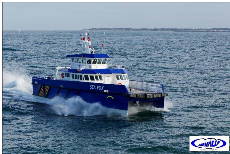
Figure 45 : Navire de maintenance typique (Source : Navalu)
