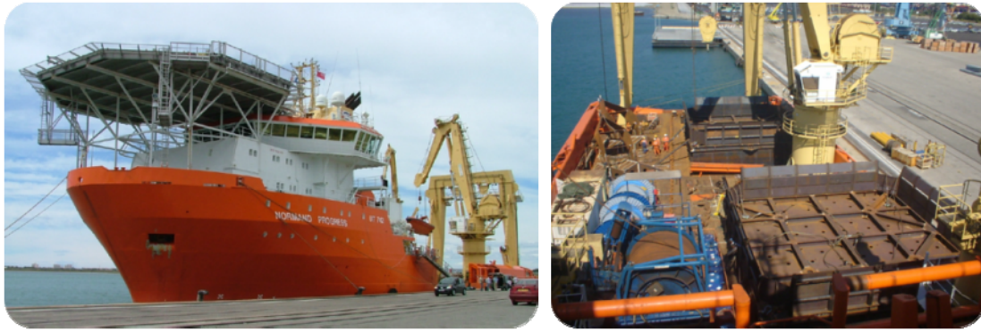
Figure 28 : Ancres gravitaires sur le pont
