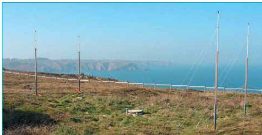
Une des 2 antennes d'émission du radar HF, installée sur la commune de Porspoder
