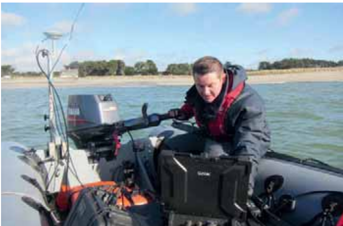
SDHM gréé sur une embarcation pneumatique (perche GPS et sondeur placés sur le tableau arrière)
