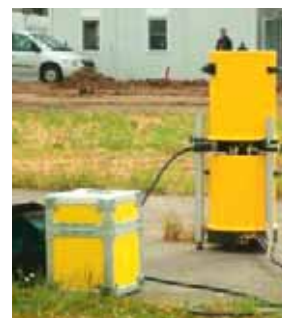
Le gravimètre A10 permet de mesurer en absolu le champ de gravité avec une précision de 10^{-7} \text{ m/s}^2
