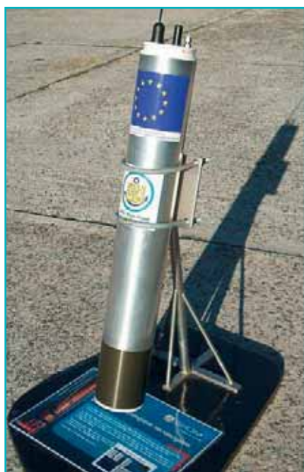
Le profileur PAOLA permet de mesurer la température, la salinité et le bruit ambiant dans la colonne d'eau jusqu'à une immersion paramétrable de 500 m maximum
