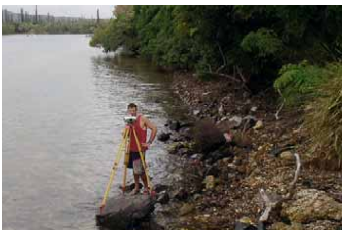
Mesures de tirant d'air par niveau : levé de la passe de la Sarcelle à l'Île des Pins
