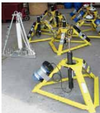
Mouillages types de la campagne Courants3D installés par plongeurs
