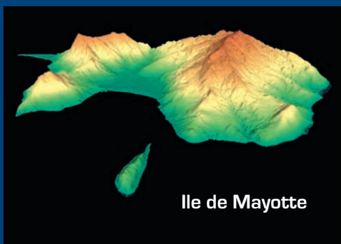
Levé laser topographique de la bande littorale et de l'intérieur de l'île
