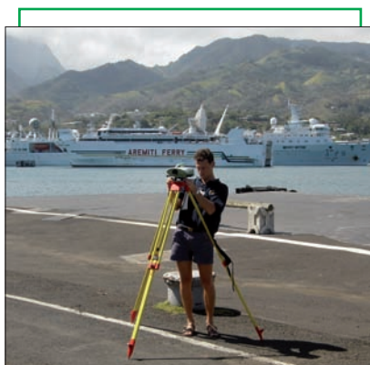
Nivellement des repères de l'observatoire de marée de Papeete
