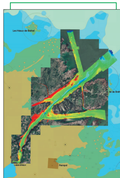
Résultats du levé surfacique de la rivière du Trieux, sur image composite d'orthophotolittorales et fond de carte marine électronique
