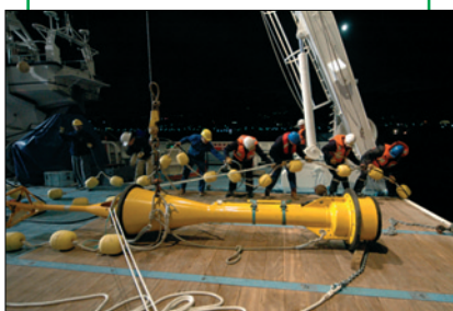
Mise en œuvre de la bouée Télémaque pour la tomographie océanique passive, dans le cadre de la campagne COACH, réalisée avec le NURC en Méditerranée
